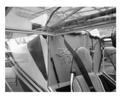
※ 新型のRANS S6-S、S12等に使用されているドア開閉用のパーツです。従来のRANS S-6等はドアを開けた状態 にするためには、主翼下面の金具にドアハンドルを固定していましたが、このシステムを使用することで、ドアを開 けるだけで好きな位置で留まってくれるので、ドアの開閉がスムーズになります。
