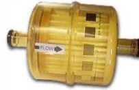
※中の見えるインラインのエアフィルターです。FAAの認定品で、ビーチクラフトを始め下記のような多くの機体で使用されます。
