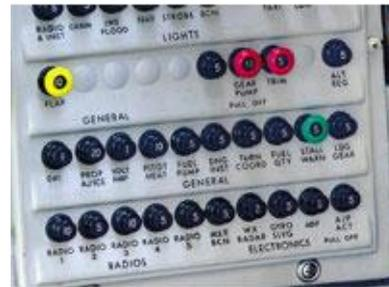
サーキットブレーカーキャップは航空機のサーキットブレーカーの目印として使用します。
