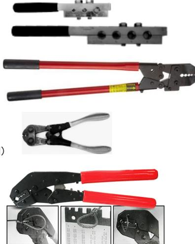
※ワイヤー製作時に使用する工具です。#12000及び#12100はボルト締めにより圧着するタイプ、その他はハンドレバータイプです。これらの作業にとって重要なことは、インチのワイヤー・インチのスリーブそしてこれらのインチの工具を使用しなければなりません。
