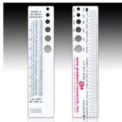
耐久性のあるビニール製でできており、スケールとルーラーが表示されています。AN3(3/16")~AN8(1/2")の太さと8"(約203mm)までの長さのボルトが測定可能です。インチとミリの換算数値の表示もあります。
