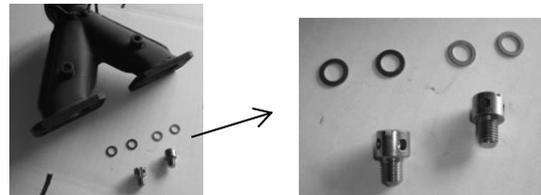
※ ROTAXのエキゾーストマニホールド(新型)のEGTセンサー(スクリュータイプ)用のスクリューとガスケットです。(EGTセンサーを使用しない場合のみ必要)
