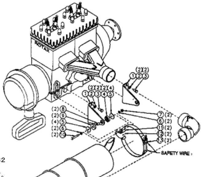
※これらのマフラー取付ブラケットセットは、ROTAXエンジンの503用及び532/582用です。溶接作業をする事なく、サイドマウントタイプのマフラーを取り付ける事が出来ます。
