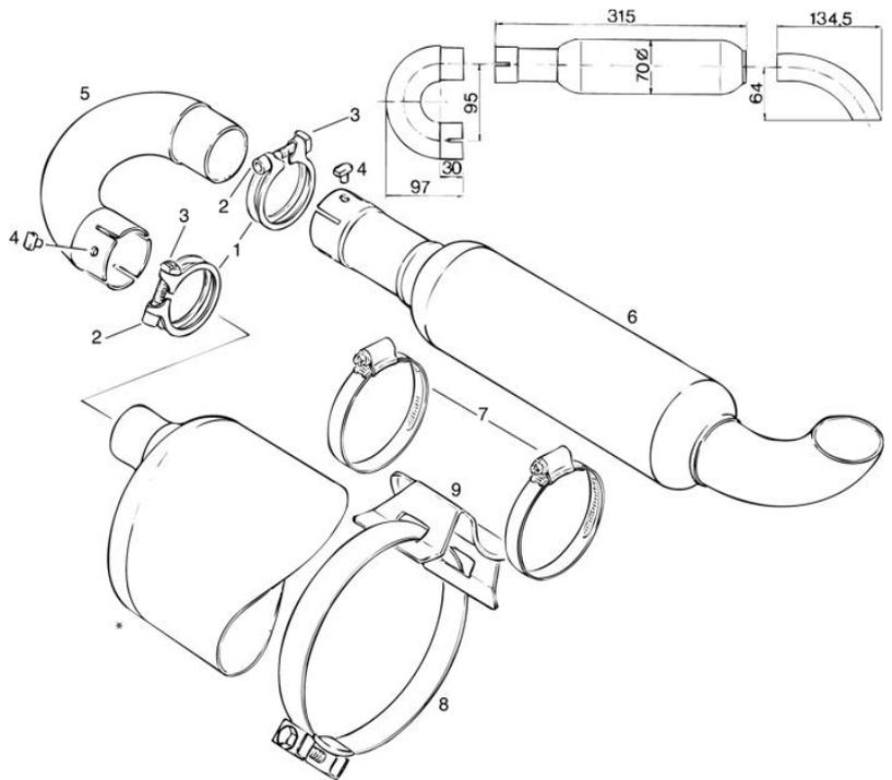
※エンジン騒音の三大要素は吸気音、排気音そしてプロペラ音です。これらの騒音の中でも特に際立って耳障りな音は排気音です。その排気音を軽減してくれるのが、このROTAX純正のアフターマフラーセットです。エンジン性能に影響を及ぼす事なく騒音を大きく軽減出来ます。インタークサイレンサー(純正)と併用して使用すると尚効果的です。Rotax Engine全タイプ(912を除く)に使用出来ます。(重量約1.7Kg)
